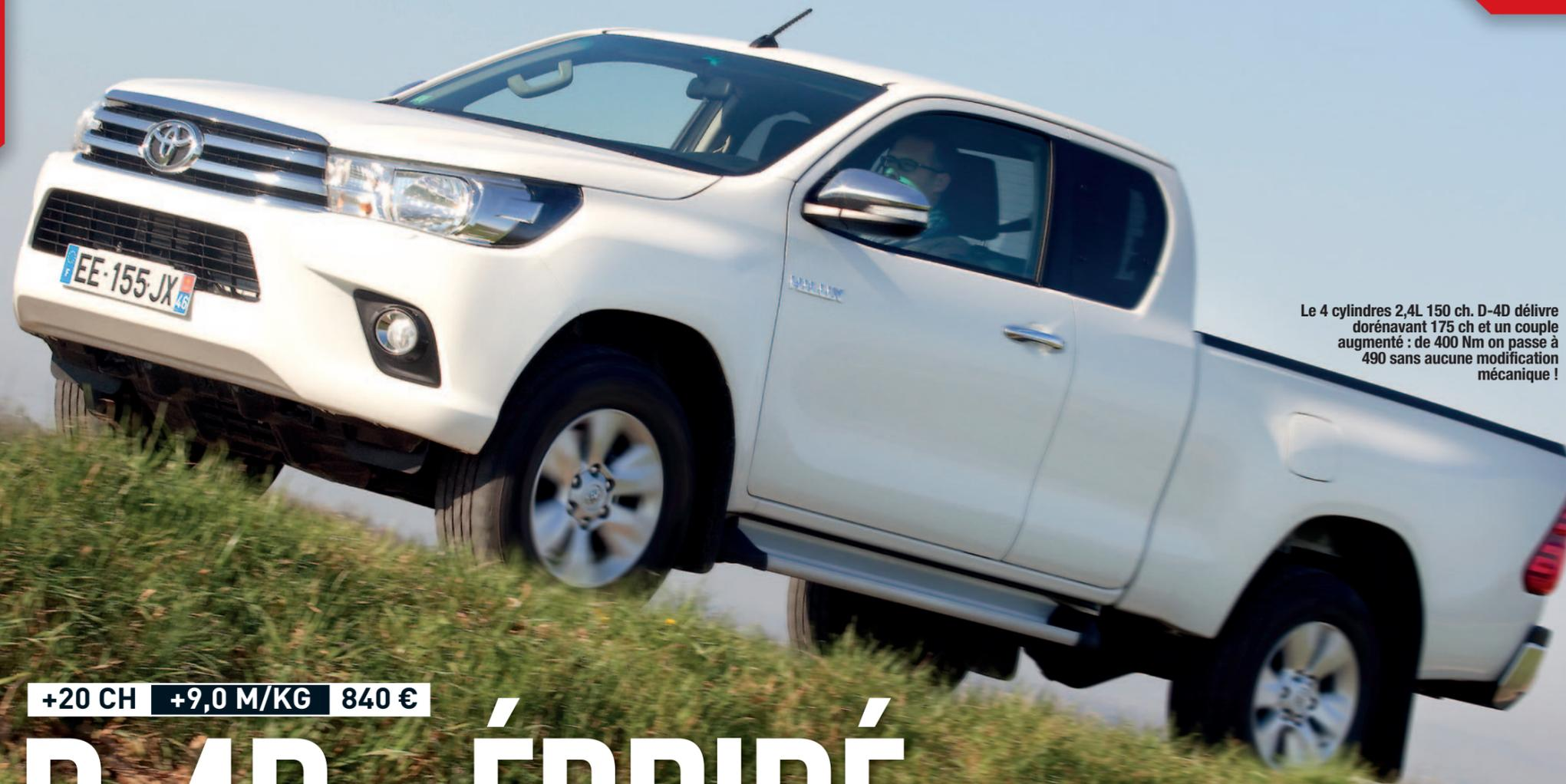
Le 4 cylindres 2,4L 150 ch. D-4D délivre dorénavant 175 ch et un couple augmenté : de 400 Nm on passe à 490 sans aucune modification mécanique !
